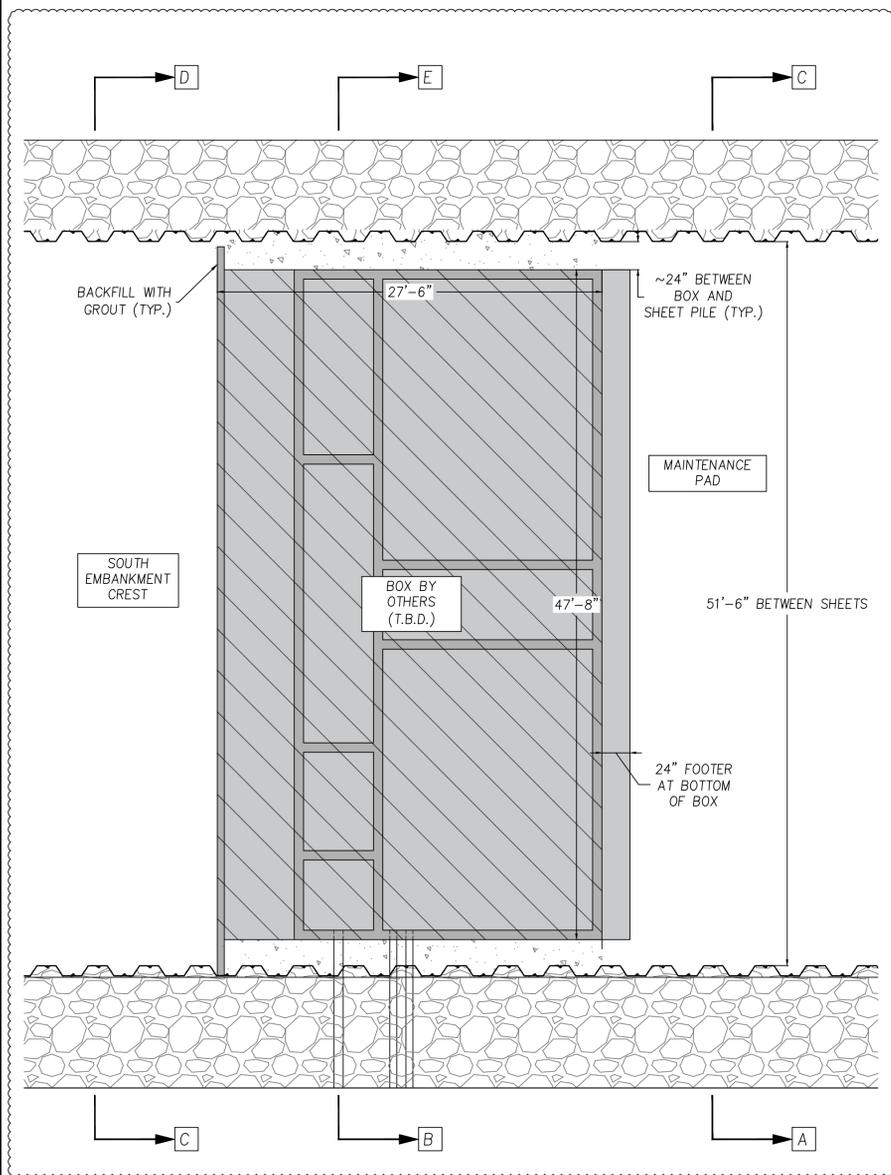
1 SHEET PILE WALL AGAINST FILTER BED
